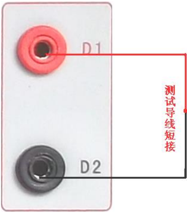
图 24，导线阻值清零接线图
